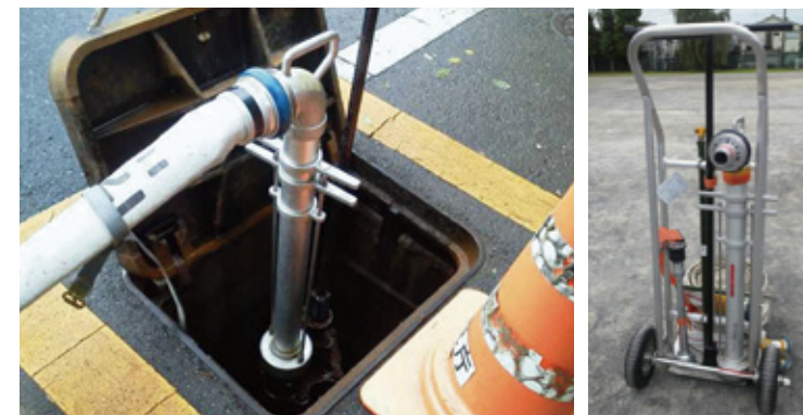
①可搬式のスタンドパイプセットを持ってきます。スタンドパイプ、スピンドルドライバー、ホースなどがセットになっています。車輪付きで軽いので移動も簡単です。
